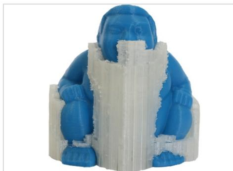
**[Foto 3 und 4] Stützstrukturen zum Abwaschen: Mit dem PVOH-basierten Polymerblend Mowiflex 3D 2000 bietet Kuraray erstmals ein Produkt für den 3D-Druck. Mit dem Filament können Stützstrukturen für anspruchsvolle Formen hergestellt werden, die sich nach dem Druck einfach mit Wasser auflösen lassen.**
